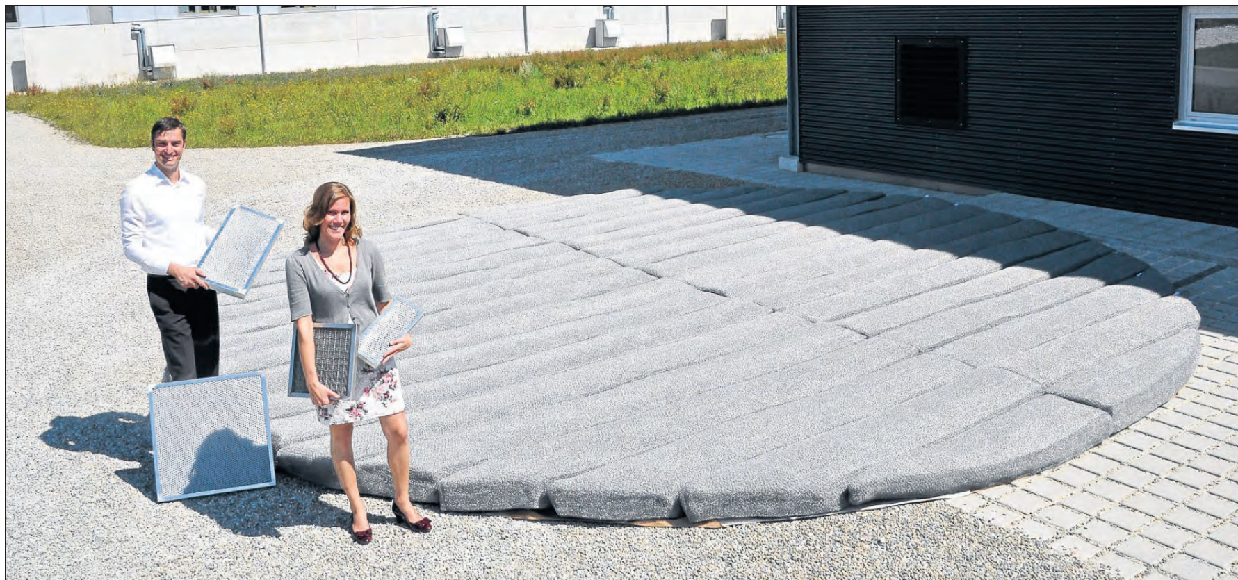
Robert und Oona Ruf haben sich mit ihrer Firma Eloona in Preith auf Umwelt- und Verfahrenstechnik spezialisiert und produzieren verschiedenste Filtereinsätze – von Dunstabzugshauben über Ölabscheider bis hin zu Filtermatten aus Duplexdraht mit acht Metern Durchmesser, die demnächst nach Indien exportiert werden. Fotos: chl
